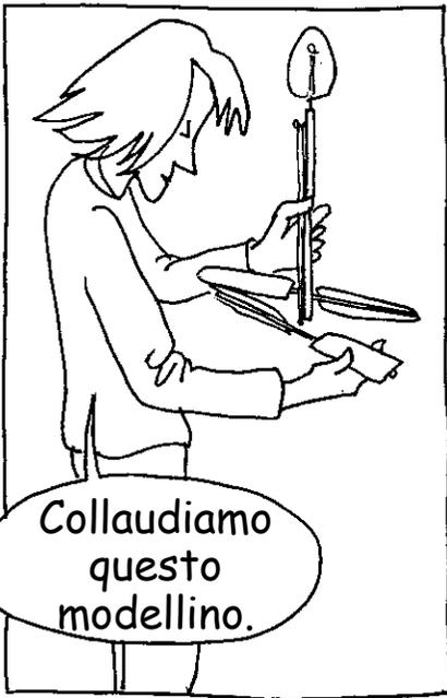
Ecco un elicottero autostabile, dotato di due rotori controrotanti di cui uno è solidale della fusoliera rotante.
