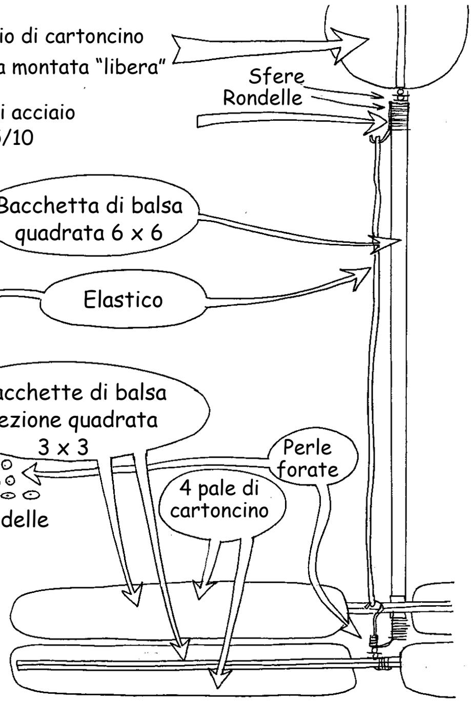
La parte delicata sta nel piegare il filo d'acciaio con l'ausilio di DUE pinze, in modo da ottenere questi particolari.
